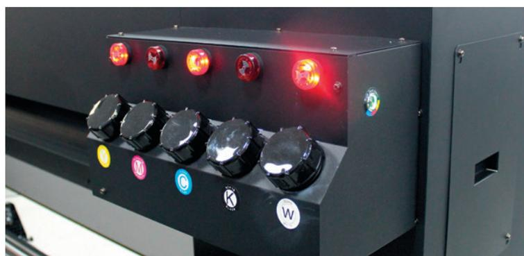
УФ-чернила Artix UV EP-E поставляются в бутылках объёмом 1 л, откуда их заливают в полторалитровые ёмкости СНПЧ. При опасном снижении уровня чернил срабатывает звуковая и световая (см. фото) сигнализация.
