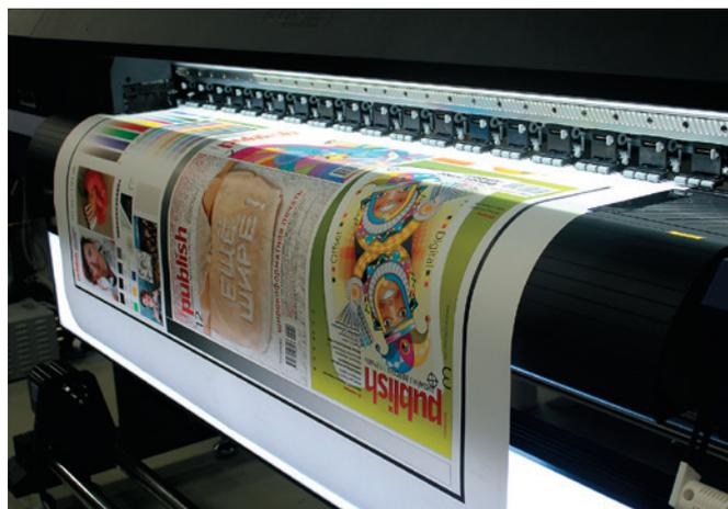
Встроенная подсветка запечатанного материала предназначена для работы с прозрачными материалами. Но фактически она облегчает оператору контроль изображения и при работу с обычными материалами — например, с самоклейкой
