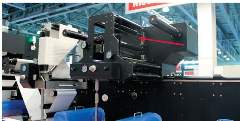
После переверота на данной машине расположен модуль холодного тиснения фольгой (показан стрелкой). Такая опция встречается у многих производителей, но именно Label Source в 2014 г. разработала тиснение со сдвигом рулона: фольга прижимается к запечатываемому материалу дважды, в разных местах из одного рулона
