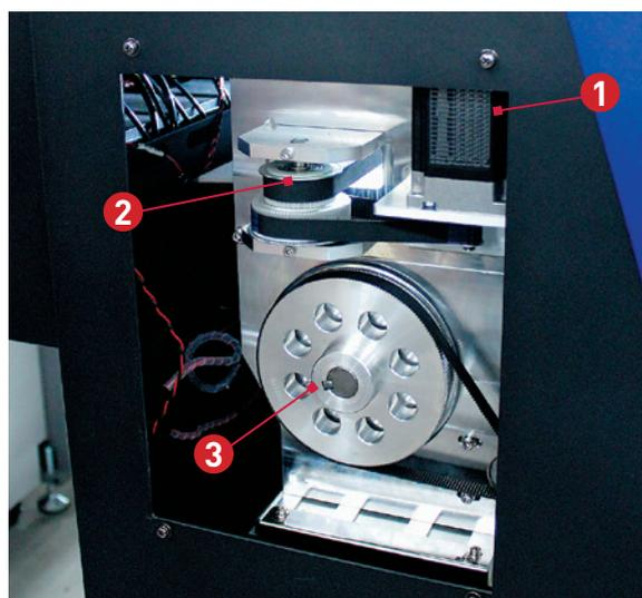
Высокоточный серводвигатель Leadshine (1) отвечает за движение каретки через ремённую передачу (2). Такой же двигатель, скрытый боковой стенкой принтера, отвечает за вращение прецизионного вала для подачи запечатываемого материала на печать (3)
