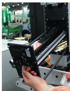
В контрольном блоке можно установить несколько различных видов камер и подсветки. Например, для проверки качества УФ-лакирования нужна специальная лампа подсветки. В свою очередь, для поиска физических повреждений нужна монохромная 3D-камера
