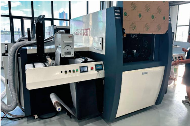
УФ-машина Naotian HTS 330-VF для цифровой отделки
