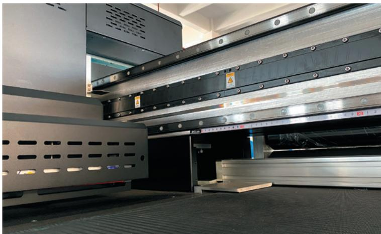
Рельсы обеспечивают отсутствие вибраций при работе каретки
