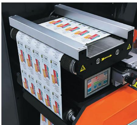
Стол для склеивания полотна и модуль для его прецизионного выравнивания
