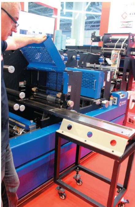
Модули системы высечки с магнитным цилиндром для гибких высечных штампов легко меняются с помощью опциональных рельсовых направляющих и тележки. Это удобнее и безопаснее, чем стандартная система с краном
