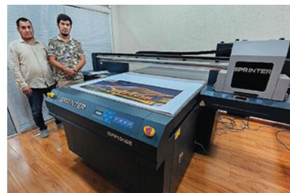
УФ-принтер Sprinter DPP 1316E был приобретён для полноцветной печати на элементах архитектурных макетов. Этот компактный станок с вакуумным столом 1,3×1,6 м оснащён тремя печатающими головками Epson i3200, печатающими переменной каплей с разрешением до 3600 dpi. Возможности печатающей системы в сочетании с насыщенными УФ-чернилами ARTIX UV EP-E в конфигурации СМΥК с белым цветом и лаком позволяют воспроизводить объекты с максимальной достоверностью.
