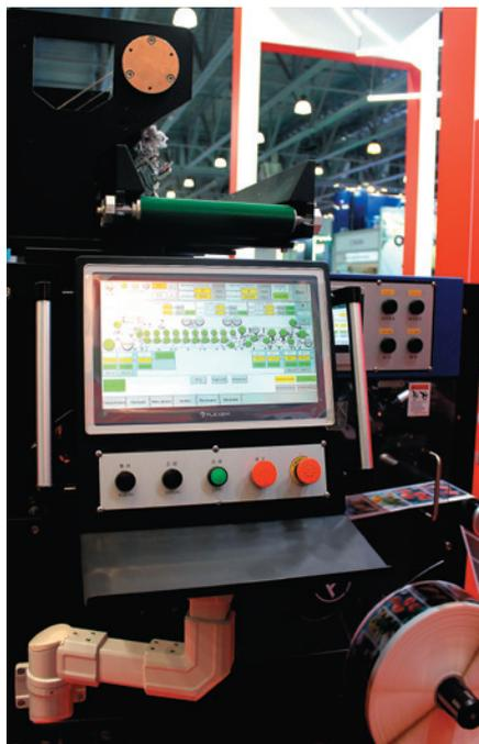
На фото видна намотка готовой продукции (в данном случае на машину установлена опциональная турельная намотка, то есть при намотке нужной длины начинается печать нового рулона, а готовый снимается), монитор управления машиной и, выше него — начало конвейера для удаления облоя
