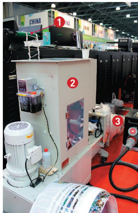
С конвейера для удаления облоя (1) отходы попадают в опциональное устройство для их переработки (2), а затем прессуются (3).
