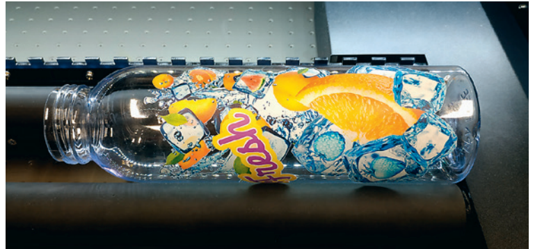
Результат тестовой печати в режиме Production на прозрачной пластиковой бутылке
